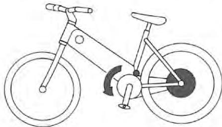
Die Bezeichnung hat sich inzwischen etabliert und steht für diejenigen Räder, deren motorische Unterstützung an die Trittbewegung des Fahrers gekoppelt ist. Das bedeutet: Nur wenn der Fahrer tritt, arbeitet der Motor mit.
